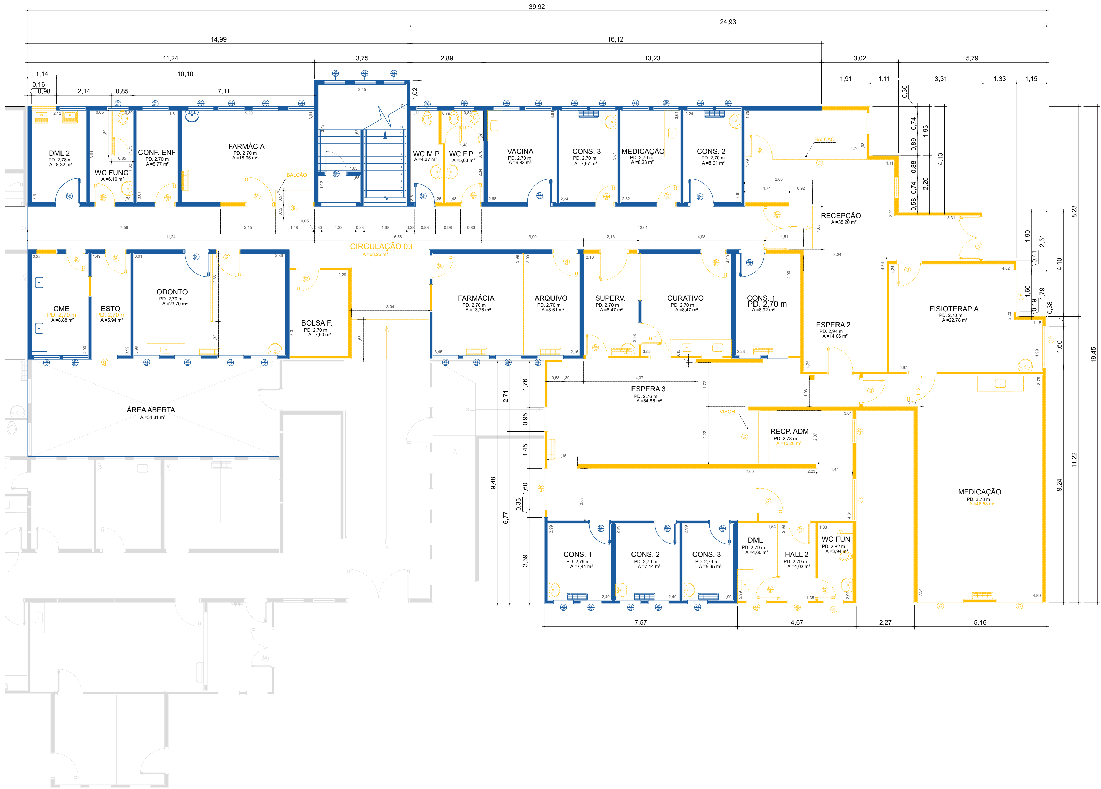
PLANTA DE DEMOLIÇÃO _PAV INTERMEDIÁRIO Escala: 1:75
